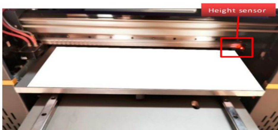
Pozycja stołu roboczego po automatycznej regulacji wysokości.
