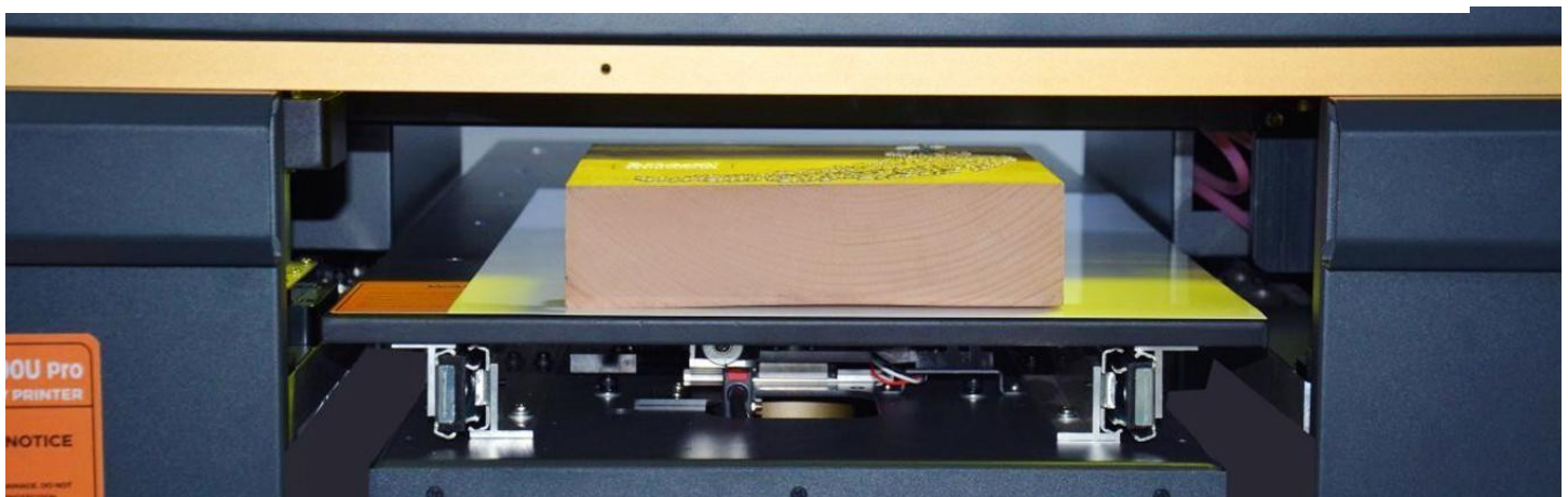
Rys. 42 – Automatyczne wykrywanie próbki i automatyczna regulacja wysokości drukowania
