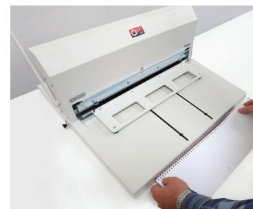
4. Następnie nałożyć przeddziurkowany dokument na grzbiet drutowy. Całość włożyć do urządzenia. Grzbiet drutowy powinien być skierowany otwartą stroną w kierunku tylnej ścianki szczeliny bindującej.
