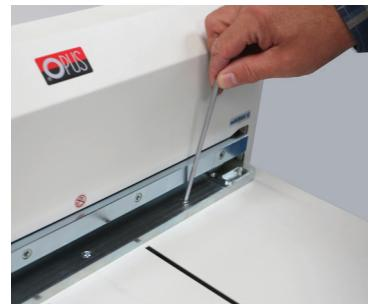
2. Przykręć moduł dołączonymi śrubami do korpusu urządzenia.
