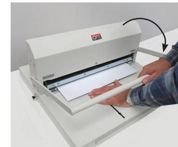
4. Pociągnij za ramię urządzenia i dociśnij do oporu w dół.
