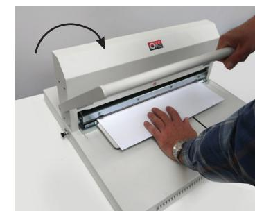
5. Pociągnij za ramię urządzenia i dociśnij do oporu w dół.
