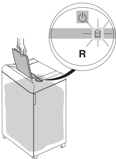
**RU** При заполнении пластикового мешка аппарат остановится автоматически. Должен загореться индикатор
