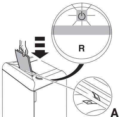
**RU** Бумага установлена по центру приемного устройства (фотодатчик) (A)
