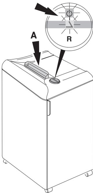
**RU** Аппарат автоматически остановится, если шторка безопасности (A) открыта (индикаторы  $\triangle$  и  $\odot$  будут загораться поочередно). Закройте шторку безопасности и нажмите кнопку  $\odot$  - аппарат продолжит уничтожать бумагу. Машина может работать некоторое время в реверсном направлении с открытой шторкой безопасности, если Вам необходимо удалить обрезки бумаги или произошло её замятие.
