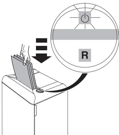
**RU** Останавливается автоматически при превышении количества уничтожаемой бумаги. Реверс включается автоматически, если произошел затор бумаги. (Индикатор "ON/OFF"
