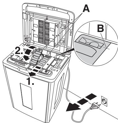
**PL** W przypadku, gdy kartki papieru nie są poprawnie pobierane przez pasy podajnika (patrz strona 44), mimo iż zostały wcześniej oczyszczone, należy wyciągnąć cały zespół podajnika (**A**). Do celów serwisowych lub w przypadku zacięcia papieru prosimy o wyciągnięcie zespołu podajnika (**A**). Aby to zrobić należy:
