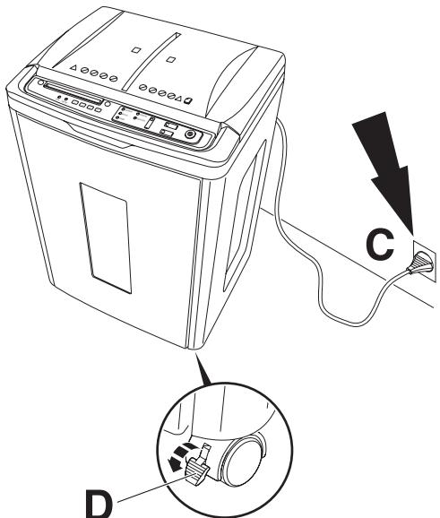
**SV** Ta ut avfallsbehållaren för CD-skivor (**A**) från ned nedre delen av förpackningen och placera den i avfallsbehållaren för papper. Skjut in avfallstunnan (**B**). Anslut väggkontakten (**C**).
