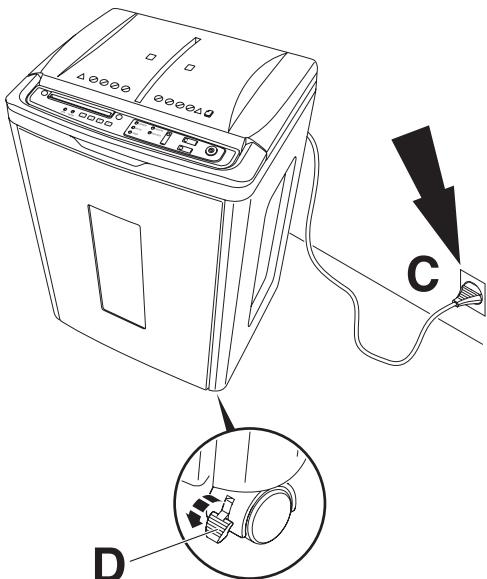
**DE** CD - Abfallbehälter (**A**) aus dem Unterteil der Verpackung nehmen und in den Papier - Abfallbehälter einstecken. Behälter einschieben (**B**), Stecker in Netzstecker (**C**) einstecken.
