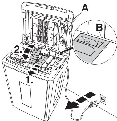
**NL** Indien de vellen papier niet goed worden doorgevoerd ondanks dat de doorvoer strips (zie pagina 43) zijn gereinigd wissel dan de complete doorvoer unit (**A**). Bij papierstoring of in geval van onderhoudsredenen verwijder dan toevoerunit (**A**).
