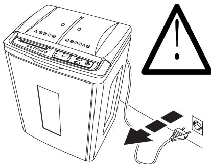
**DE** Bei der Reinigung Netzstecker ziehen!
